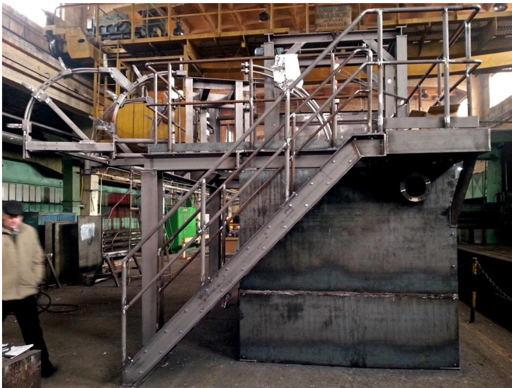
Drahtbehandlungsstation für eine Gießerei in Mexiko im Rohbau
