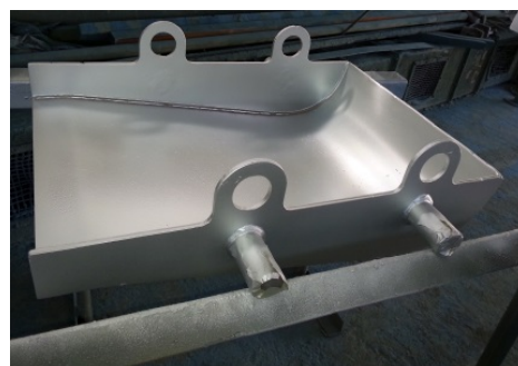
Gießband für Kupfermasseln beim Probeaufbau
