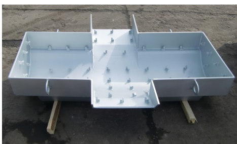
Gießband für Kupfermasseln beim Probeaufbau
