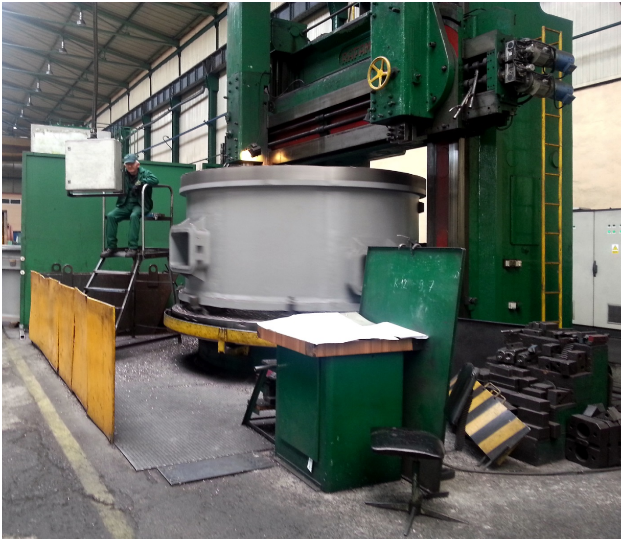
Drehteile bis 2,6m Durchmesser
