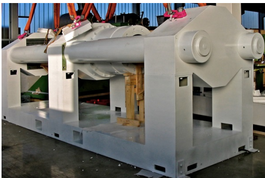
Duplexporzellanpresse zur gleichzeitigen Herstellung von zwei Werkstücken
