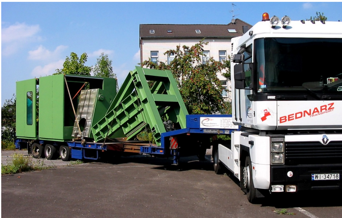
Rohrwaschanlage für Großrohre bis 56" mit Zweikreiswaschkopf für Emulsion und Reinwasser zum entfernen des Expanderöls vor der Beschichtung
