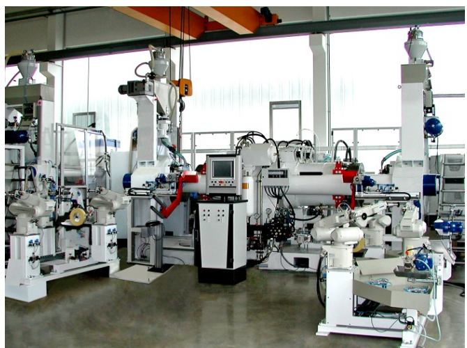
Duplexporzellanpresse zur gleichzeitigen Herstellung von zwei Werkstücken
