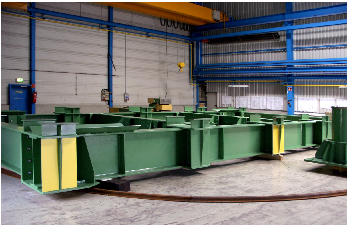
Drehrahmen für Rollgänge 12m
